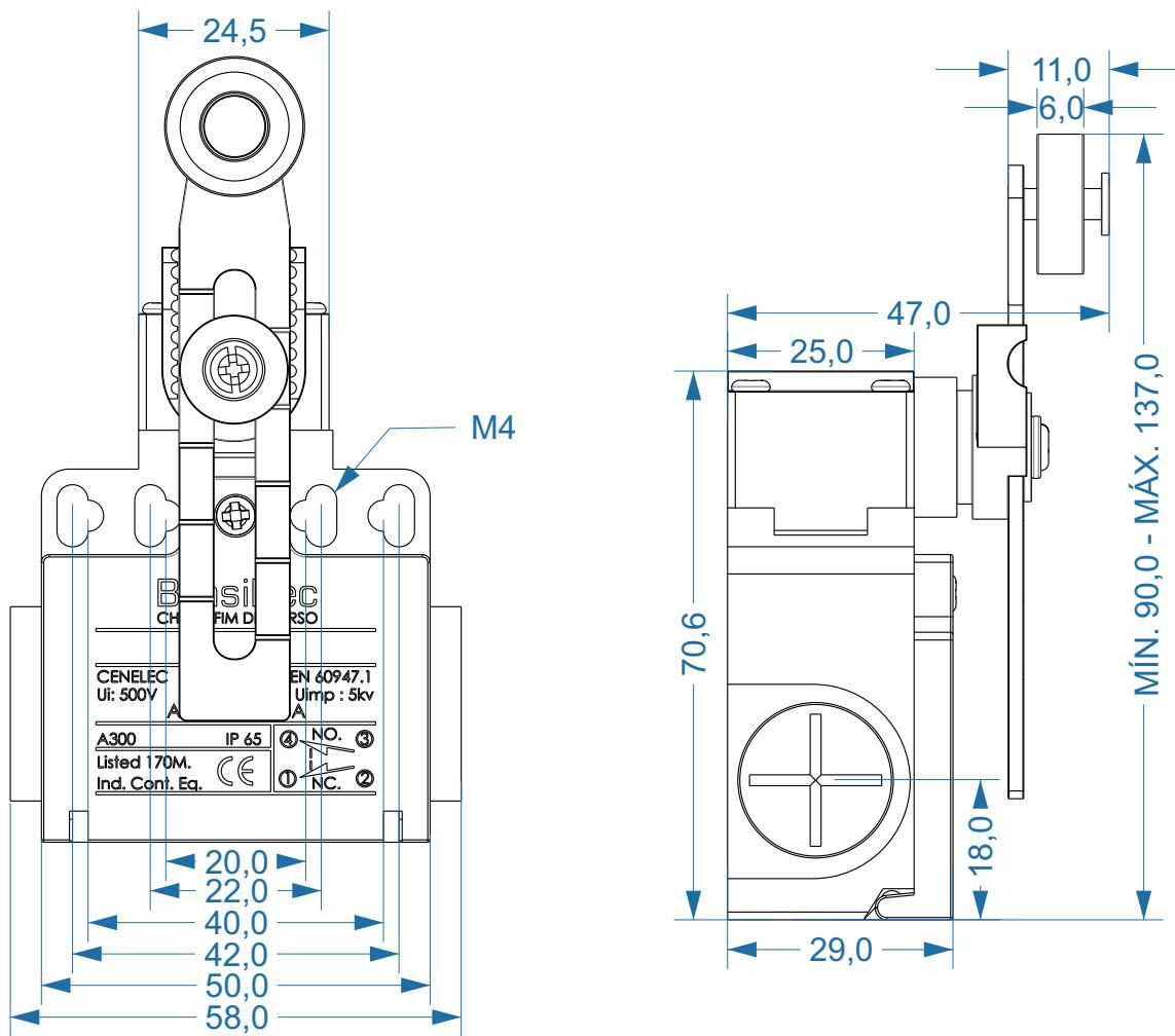
CABEÇOTE PODE SER MONTADO VIRADO PARA QUALQUER DIREÇÃO
